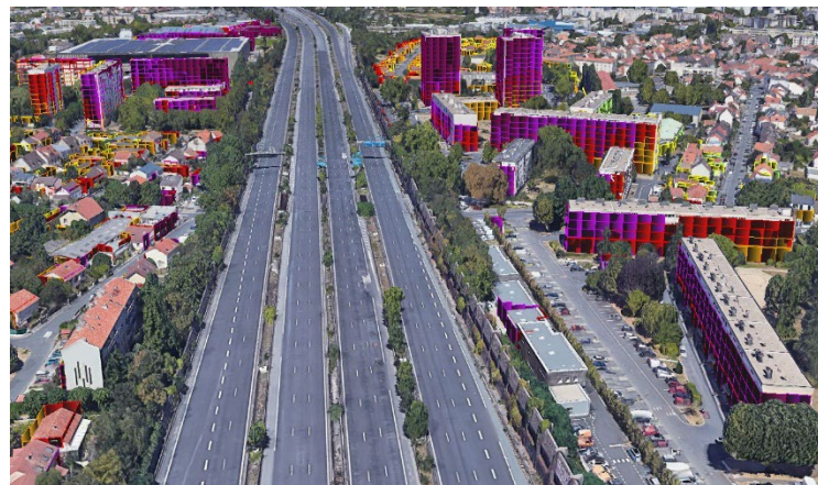
Cartographie du niveau sonore Lden) en façade des bâtiments avant la pose du revêtement antibruit
